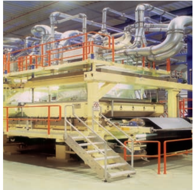
Airlade-Anlage der Firma Concert GmbH – Herstellung luftgelegter Zellulosevliesstoffe
